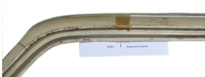
Рис.4 Установка шаблонов. Вид снаружи автомобиля
