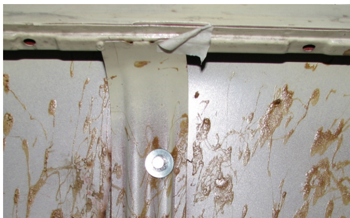
Рис.5 Крепление рейлинга. Передний кронштейн
